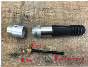
Auf der Dichtung die Verschmutzung entfernen
