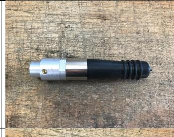
Die Verschraubung gegen den Uhrzeigersinn öffnen
