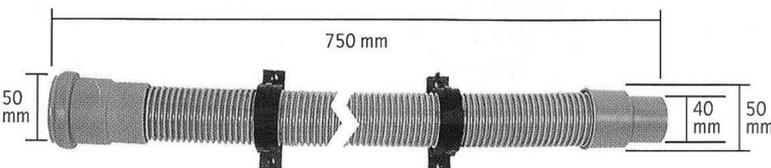
70125 Ablaufschlauch Gipsabscheider/Abflussleitung
