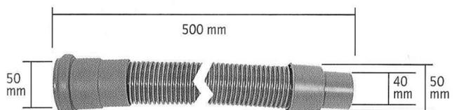
70124 Ablaufschlauch Gipsabscheider/Abflussleitung
