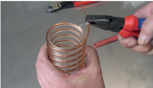
6. Biegen Sie den Draht um 90° nach außen.
